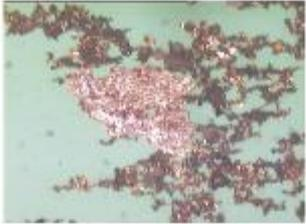
**Értékelés:** Ferrográfias vizsgálatnál kritikus szintűen csúszóparticulusok láthatóak. A csúszó- és alumínium lócsoktól származó részecskék túlsúlyban vannak. Az elemzésből részelt belső túlsúlyosságok is láthatóak. Néhány az olaj szennyezőanyag-maradványai, a szilárd felhárítások részecskéi is láthatóak. A szilárd részecskék gondatlanul kevertek lehetnek.
