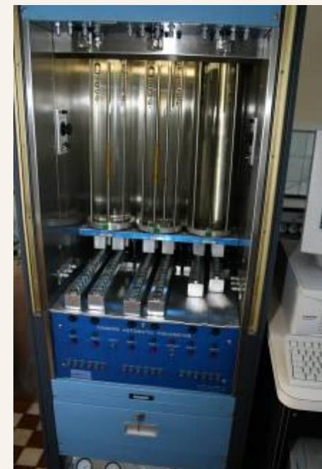
▶ Феррография – уникальный инструмент для определения источника продуктов износа
